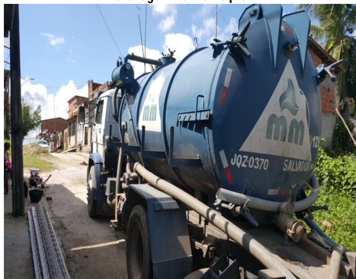
Figura 87 -Fotografia de caminhão com equipamento Vacall utilizado na limpeza fossas e canais de drenagem no município.
